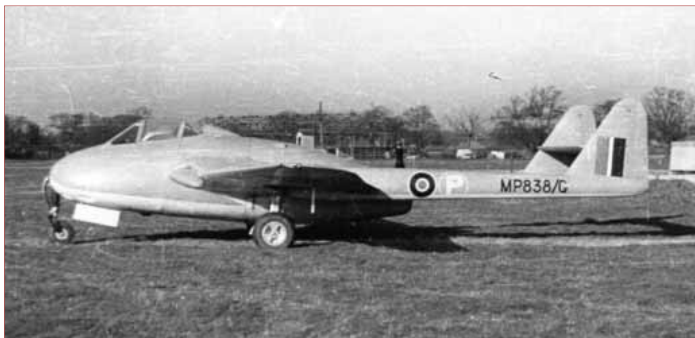
Le deuxième prototype Vampire, avec les dérives longues des débuts. (Photo officielle, coll. D. Watkins)
