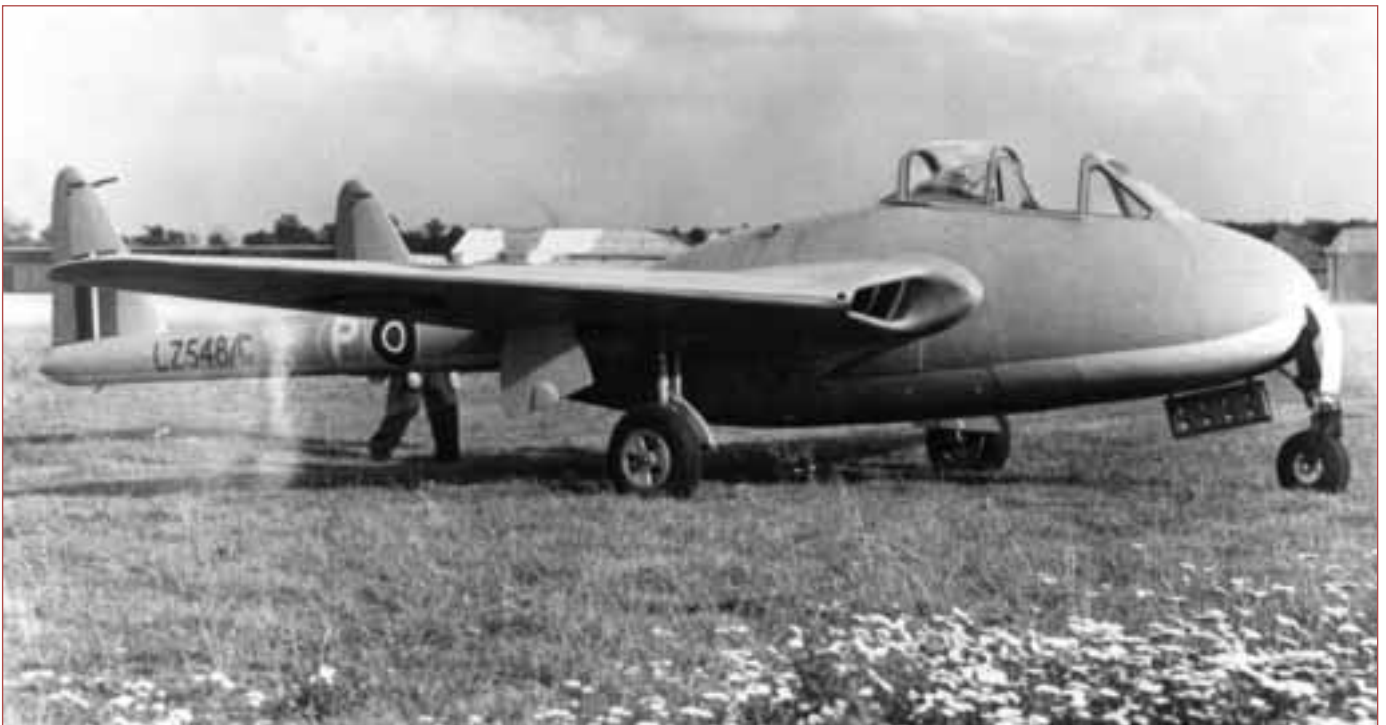
Le prototype original du Spider Crab LZ548/G. Remarquer la verrière en trois parties, et la lettre P dans un rond jaune sur la poutre, attestant de l'état de prototype financé par le Gouvernement. (Photo DR, coll. D. Watkins)
