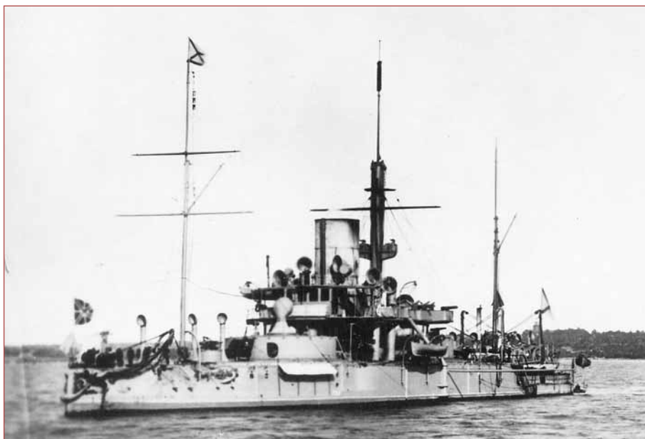
Piotr Velikiï après refonte complète de 1905-1906 qui lui donne une réelle silhouette de navire de ligne. (DR)
