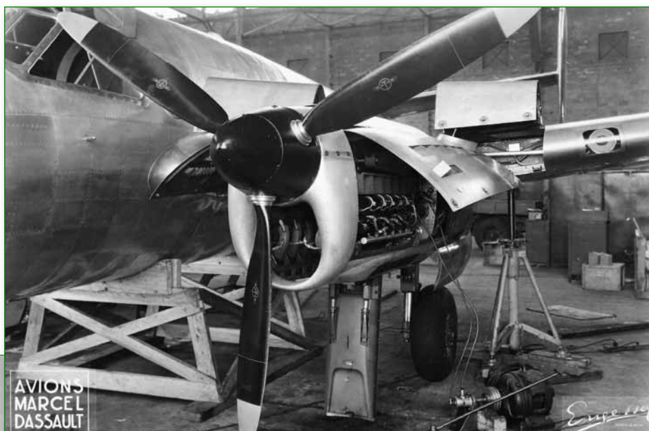
Gros plan sur l'installation motrice (moteur Renault 12S et hélice Ratier) du MD.315 n° 01 dans le hangar H2 de Mérignac. (coll. R. Lemaire)
