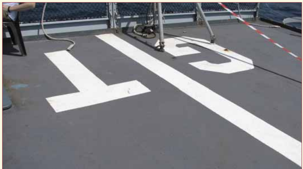
La marque sur l'arrière de la plateforme hélicoptère.
