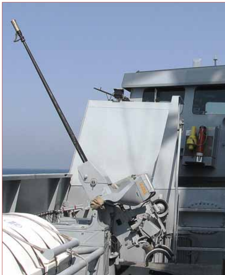
Le canon de 20 mm F2 à bâbord arrière de l'abri de navigation du Guépratte.
