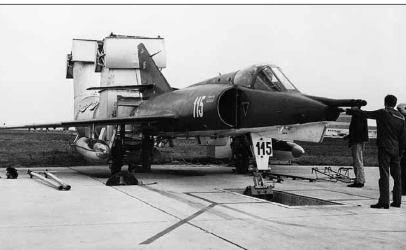
Démarrage du réacteur Atar 8C de l'Étendard IV M n° 51 à l'aire de point fixe de l'AIA Cuers. (H. Lebreton)
