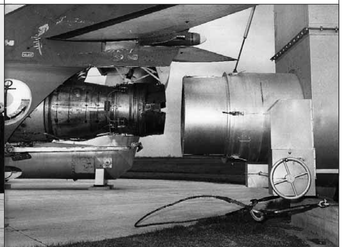
Point fixe de l'Étendard IV P n° 115 au silencieux réacteur flambant neuf de la base de Landivisau le 26 mars 1971. (MN)
