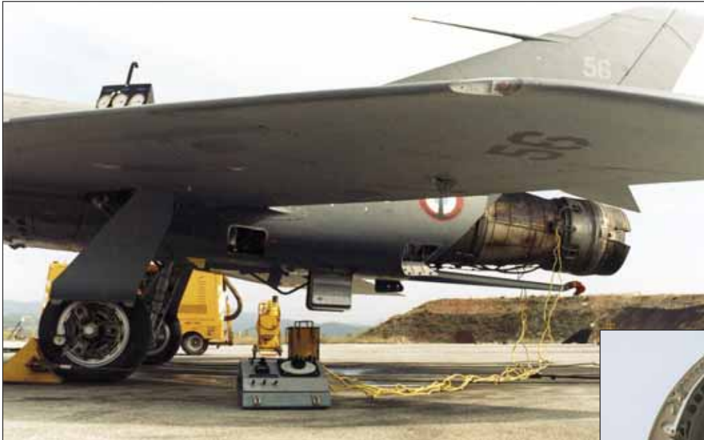
Étendard IV M n° 56 paré point fixe réacteur à l'AIA de Cuers. (H. Lebreton)
