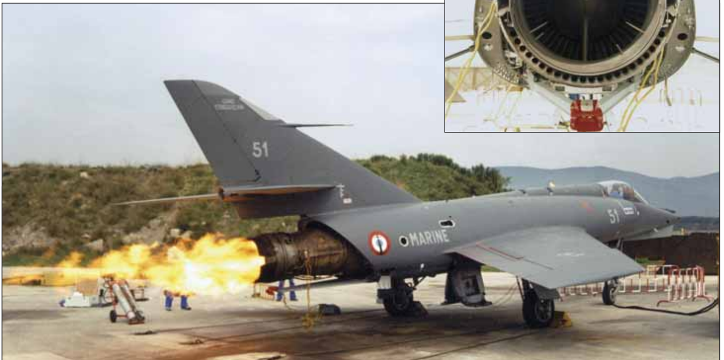
Démarrage du réacteur Atar 8C de l'Étendard IV M n° 51 à l'aire de point fixe de l'AIA Cuers. (H. Lebreton)
