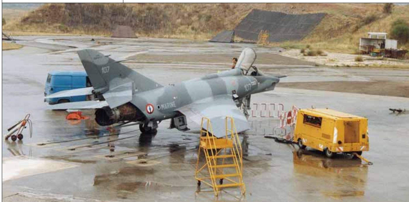
Point fixe réacteur pour l'Étendard IV PM n° 107 à Cuers en septembre 1990, après son chantier de modification... et sa peinture. (H. Lebreton)
