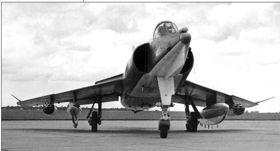
Le prototype Étendard IV M-02 équipé de lance-roquettes et de bidons "à pattes" sur l'arête inférieure. Ces bidons étranges préfigurent les bidons de 1300 l et les armes spéciales susceptibles d'être emportées par l'appareil, et dont la tenue au catapultage est essayée au RAE de Bedford, en Angleterre, en septembre 1962. (DR)
