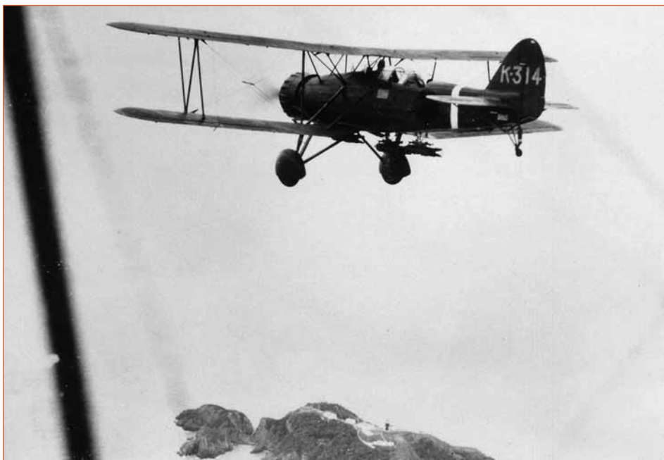
Un Yokosuka B4Y1 du porte-avions Kaga (K-314) en route vers son objectif dans le secteur de Canton au printemps 1938 probablement. L'appareil emporte des bombes de 60 kg sous le fuselage. (Aireview)
