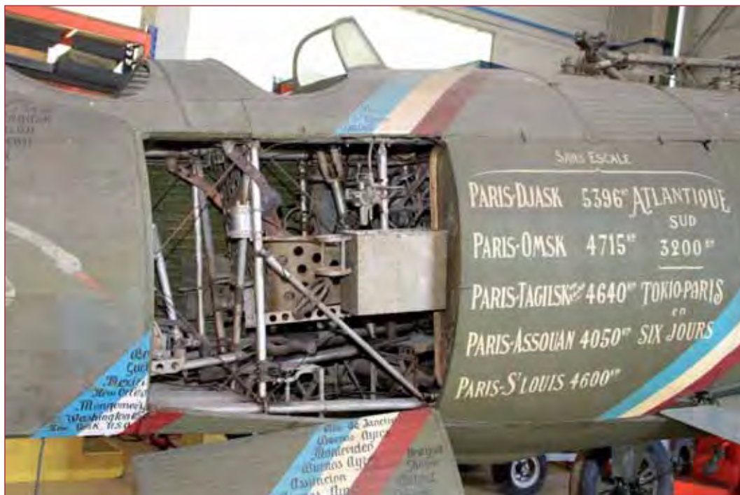
Le côté droit du fuselage, décapoté au niveau de l'habitacle pilote. Comme l'extérieur, l'intérieur de l'appareil est recouvert d'un enduit « vert émailite ». (photo Pypertote)
