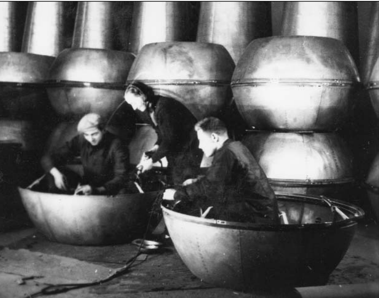
Les trois photos: Chaudronnerie des capots. (Coll. SHAA)
