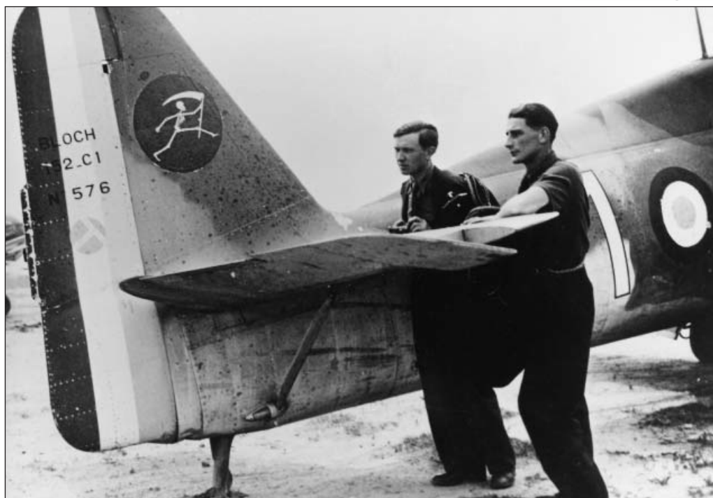
Le 20 mai 1942 au Luc, les Sgt Boyer et Lombaert devant la dérive du MB.152 n° 576 codé "11". Noter le flettner ajouré, les feux de position et la partie en bois de la béquille absente, ce qui donne un sabot à l'allure bizarre. (Coll. S. Joanne)
