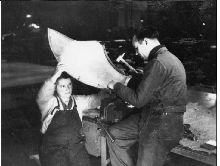
Les trois photos: Chaudronnerie des capots. (Coll. SHAA)
