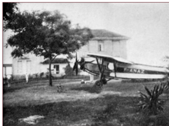
Une escale improvisée du Farman 393 F-ANAZ en Cochinchine. Cet appareil de série, qui dispose d'une autonomie de 800 km, est peint en jaune rayé de rouge. (coll. F. Roumy)
