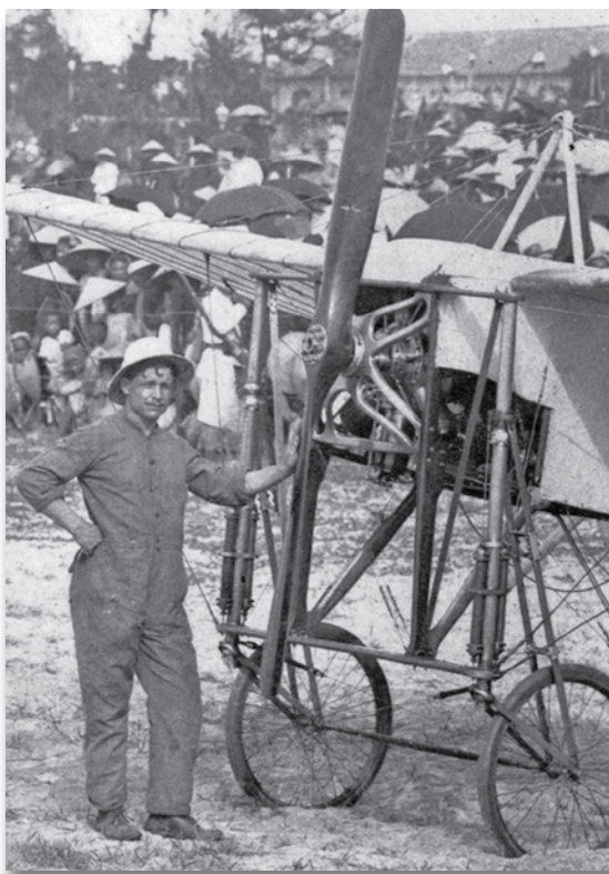
Fin avril 1913, Raoul devient le mécanicien du pilote Marc Pourpe qu'il vient de rencontrer à Saïgon. Il se fait photographier devant l'appareil de son patron, un Blériot XI à moteur Gnome 70 HP baptisé La Curieuse . (coll. Raoul Lufbery III)
