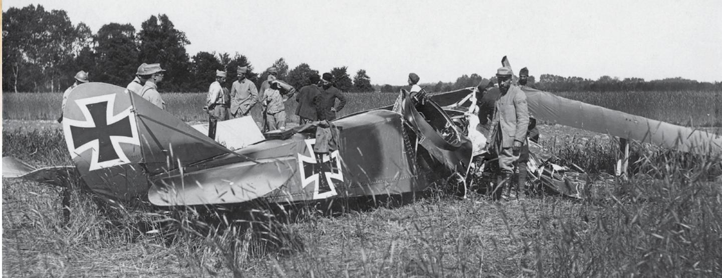
L'épave du Rumpler C.IV C.6746/16 de la FA(A) 267 tombé le 3 juin 1917 au nord de Vadenay est examinée par les fantassins français. L'avant de l'appareil s'est disloqué sous le choc, provoquant la rupture du fuselage au niveau du poste de l'observateur.
