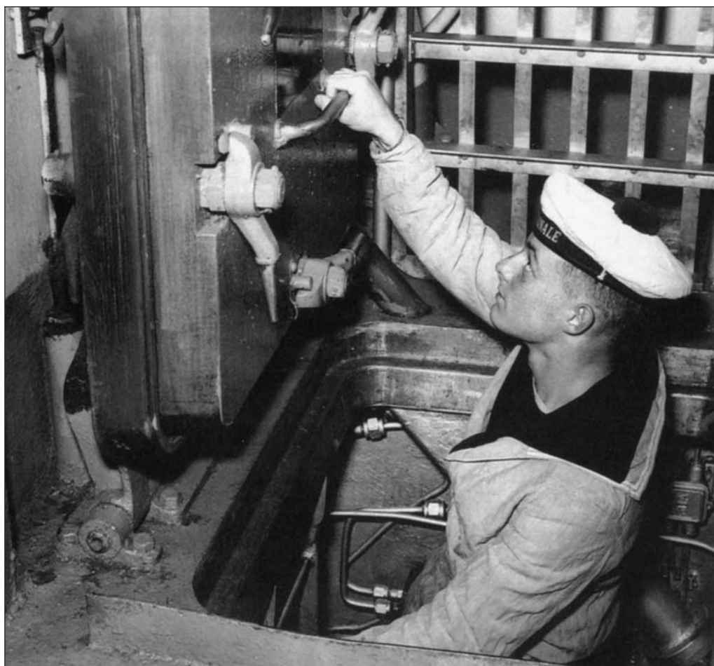
Ce panneau nous montre bien l'épaisseur du pont blindé inférieur. (ECPA)
