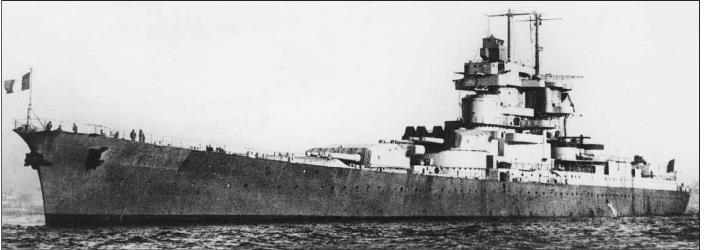
Le télépointeur principal est maintenant en place, ainsi que les braies de protection sur les pièces de la tourelle II. (DR)
