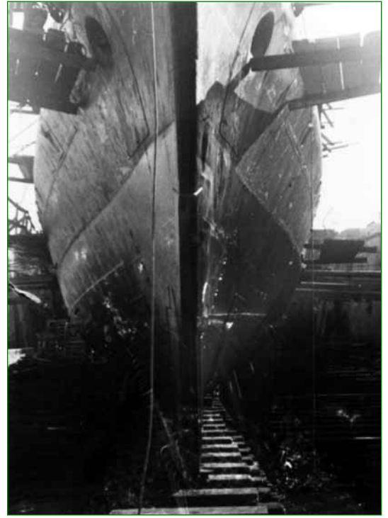
Toujours le Commandant Duboc en grand carénage à Sidi Abdallah, on peut voir ici l'étrave et la poupe avec les deux hélices.
