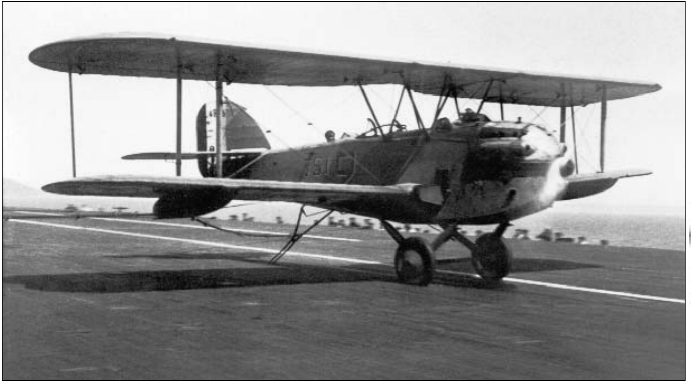
Appontage du 7S1.2 qui nous permet d'observer la crosse dont le crochet a pris le câble.
