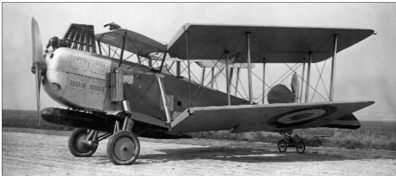
Trois vues du PL.2 n° 5 de série. L'appareil est biplace mais il n'emporte qu'un seul homme d'équipage en mission torpilleur.
